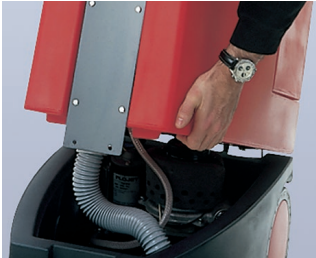
Guter Zugang zum Tank
