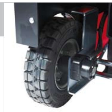
Hinterradantrieb bei Verbrennungsversionen Rear-wheel drive for combustion engine versions
