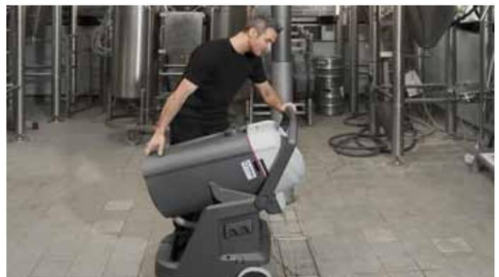
Das Ergo-Kippsystem ermöglicht ein einfaches und schnelles Entleeren des Behälters. Ein Abnehmen des Motorkopfes ist nicht mehr notwendig.
