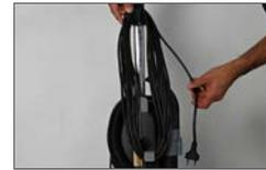
Kabel aufwickeln, reinigen mit feuchtem Tuch
