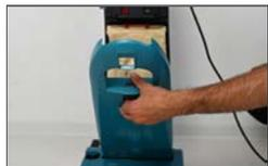
Filterraumdeckel öffnen und vollen Staubbeutel herausnehmen
