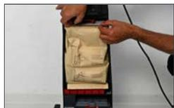
Neuen Staubbeutel mit der Haltescheibe auf den Stützen im Behälter aufsetzen und bis zum Anschlag nach hinten schieben.
