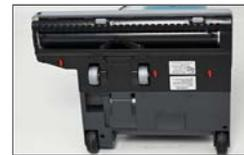
Bodenplatte aufsetzen und verriegeln. Darauf achten, dass die Haltenocken der Bodenplatte an der Vorderkante des Gehäuses eingerastet sind
