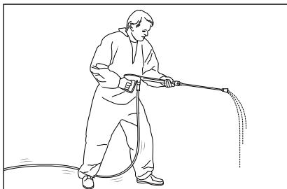
Aus der Lanze kommt ein unregelmäßiger Strahl. Der Hochdruckschlauch vibriert.
